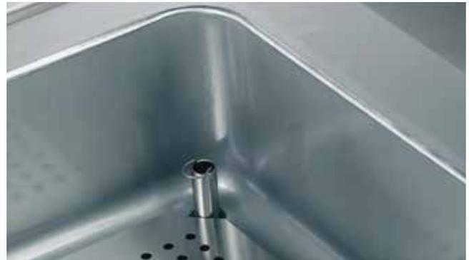
22-Liter-Becken aus Chromnickelstahl 1.4301 mit 15 mm Verbundbodenplatte – 12 mm Unterschicht aus Weichstahl in Verbindung mit einer 3 mm starken Deckschicht aus korrosionsbeständigem Chromnickel-Molybdänstahl 1.4401
