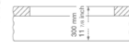
Ausschnittmaß Seitenansicht Cut-out dimension, side view Côte de coupe, vue de côté
