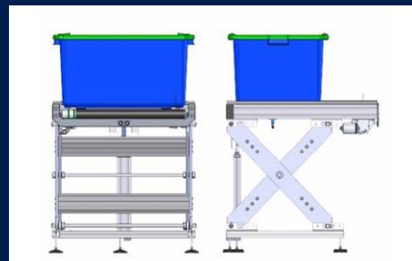
Ideal für unterschiedliche Bedürfnisse, z. B. zur Gewichtsmessung auf Rollenbahnen in Automatisierungsprozessen und Packstationen
